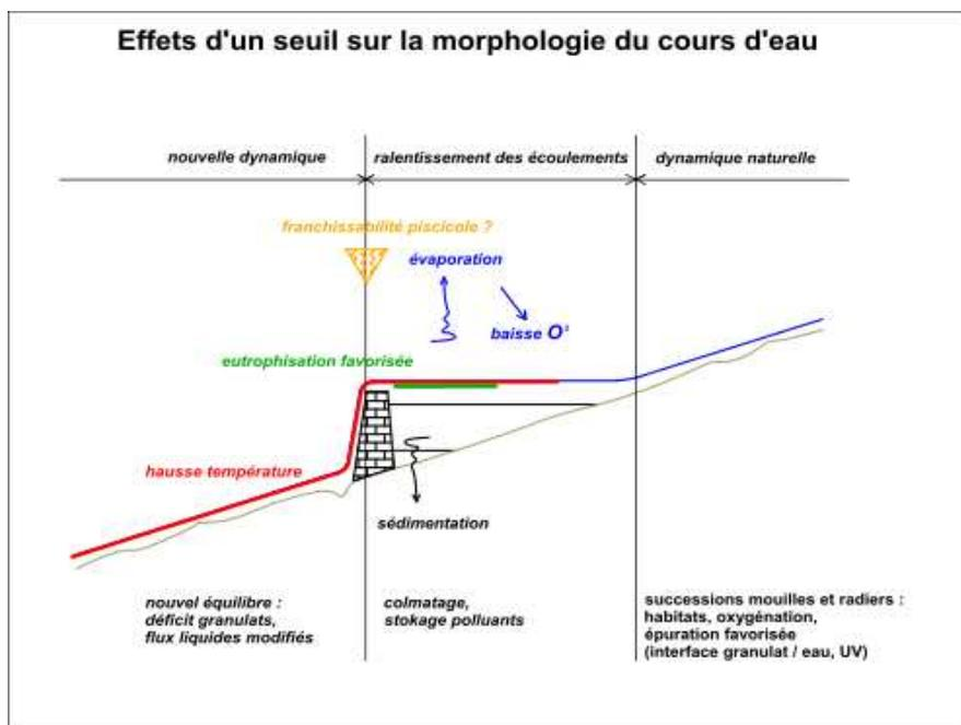
Figure 66. Effet d'un seuil sur la morphologie d'un cours d'eau
